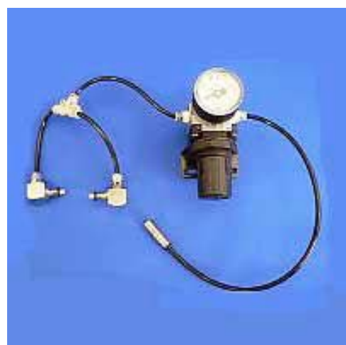
設定圧力範囲: 0.02 ~ 0.2 MPa 水素吸蔵合金ポンペを2本同時に接続できるタイプです。
